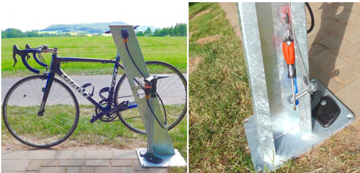
Fahrradserviceständer mit Luftpumpe und Werkzeug aus dem Eichsfeld. Zusätzliche Ausstattung mit zwei Steckdosen ist möglich. Quelle: erste-fahrrad-hilfe.de/ © MScholle.
